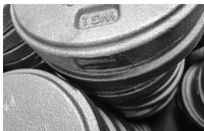
Fot. 9.1. Zdjęcie podglądowe niezgodności detalu z oznaczonym miejscem występowania Źródło: materiały firmy Metalpol sp. z o.o.
